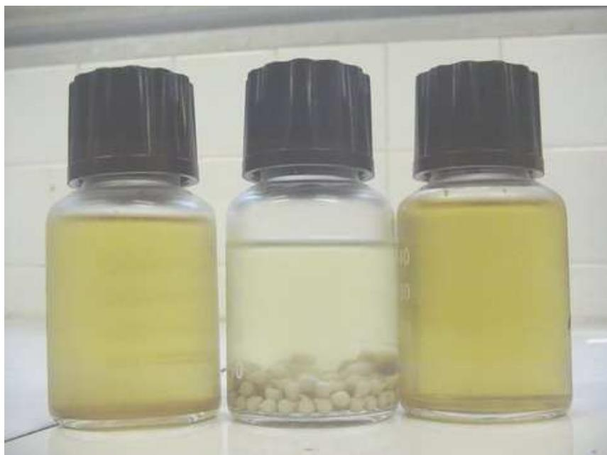
**Figure 73 : Bouteillons remplis avec le vin seul (à gauche et à droite) et le vin contenant le piège à oxygène (au milieu) après 12 jours d'essai à 30°C.**
