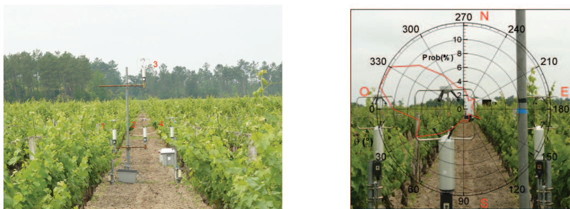
Figure III.3 – (a) Vue de la parcelle de vigne expérimentée avec le montage du système d'anémomètres soniques. (b) Distribution de la direction du vent durant l'expérimentation.
