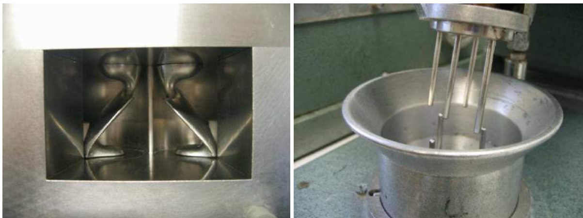
Fig. 1.12: Géométrie des systèmes de pétrissage du farinograph (à gauche) et du mixograph (à droite).
