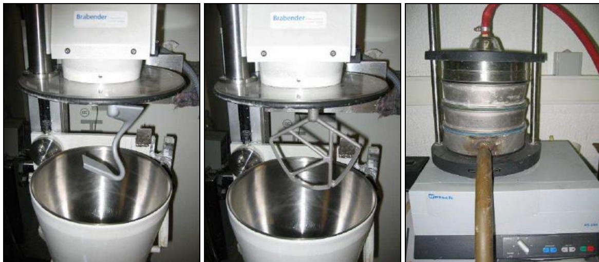
Fig. 1.13: Photos du procédé d'extraction du gluten utilisé dans cette étude: (gauche) pale hélicoïdale de pétrissage montée sur le bol P600 de Brabender, (centre) pale en K de lavage et (droite) tamiseuse automatique en voie humide.
