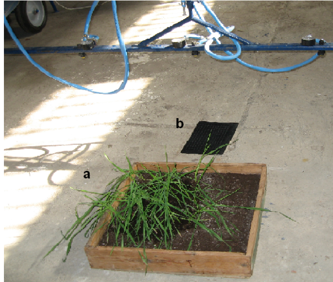
FIGURE 5.7 – Dispositif de mesure des dépôts au sol et de la rétention des plantes sous la rampe en conditions de laboratoire. (a) Mesure de la rétention (b) Mesure des dépôts au sol.
