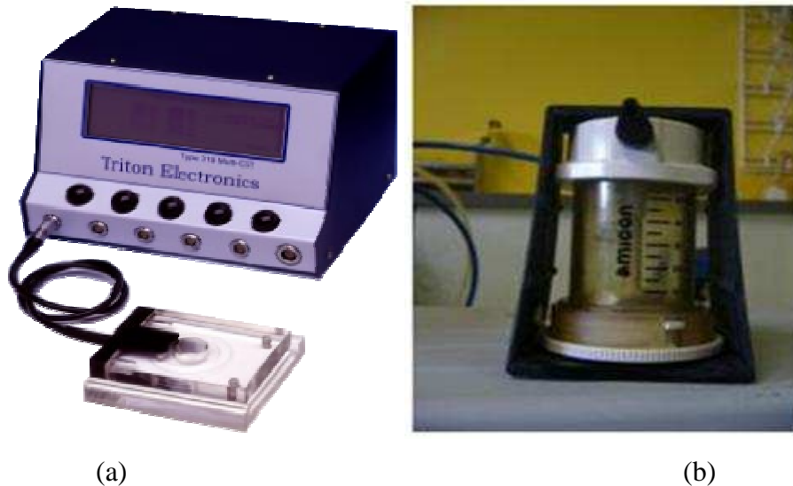
Figure 22 : (a) CST-mètre Triton type 319 Multi-CST (Triton Electronics Limited.) et (b) cellule de filtration pressurisée de type Amicon (série 8010).
