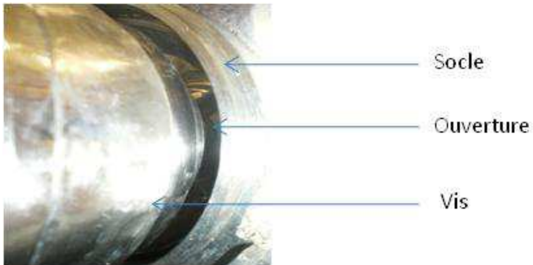
Figure 18 : Ouverture entre le socle et la vis sans fin de la presse.
