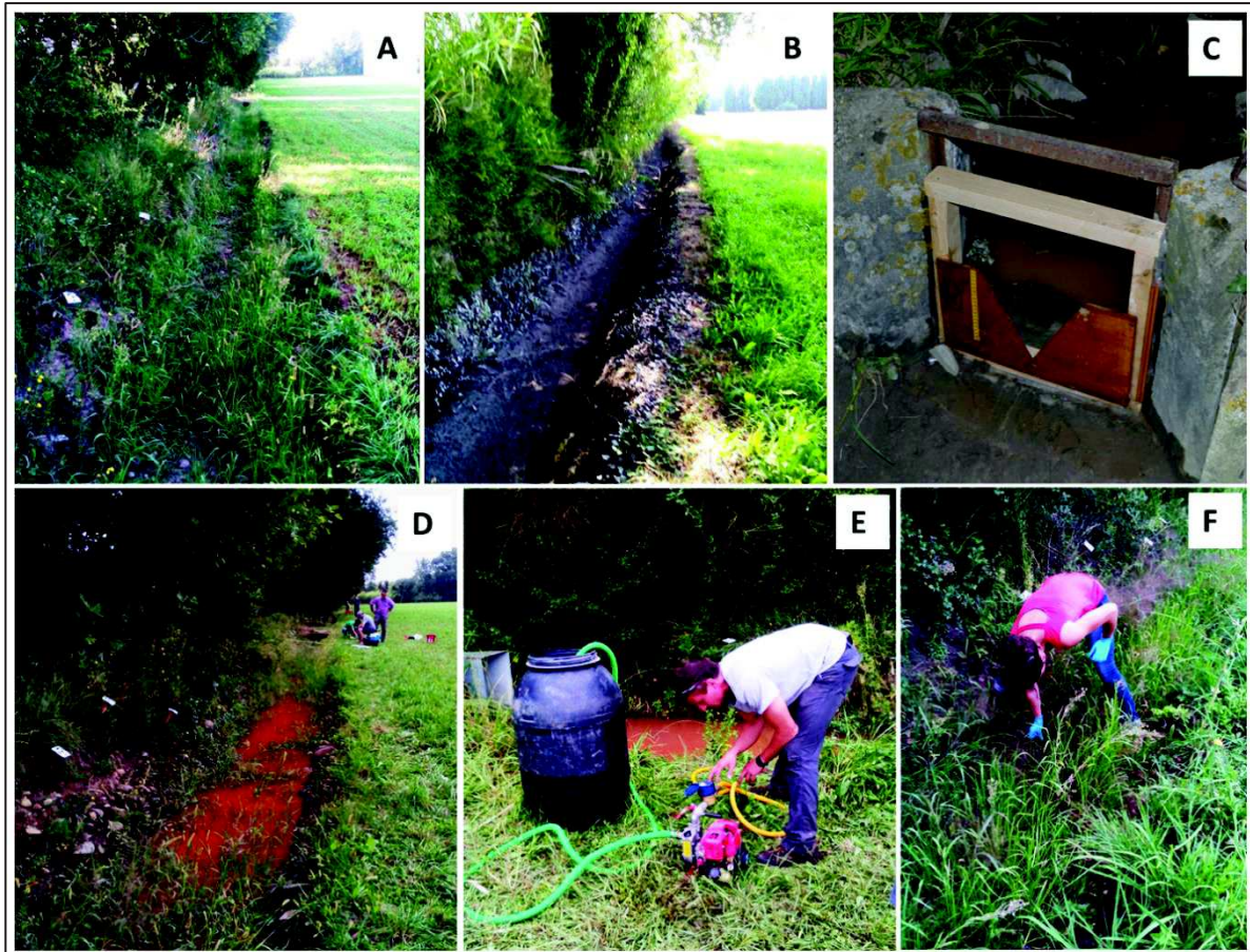
Figure 5.2 : A : fossé A - B : fossé B - C : seuil triangulaire et sonde DIVER enregistrant les hauteurs d'eau - D : suivi des paramètres hydro-chimiques à l'aval - E : dispositif d'injection des traceurs - F : prélèvements des échantillons.
