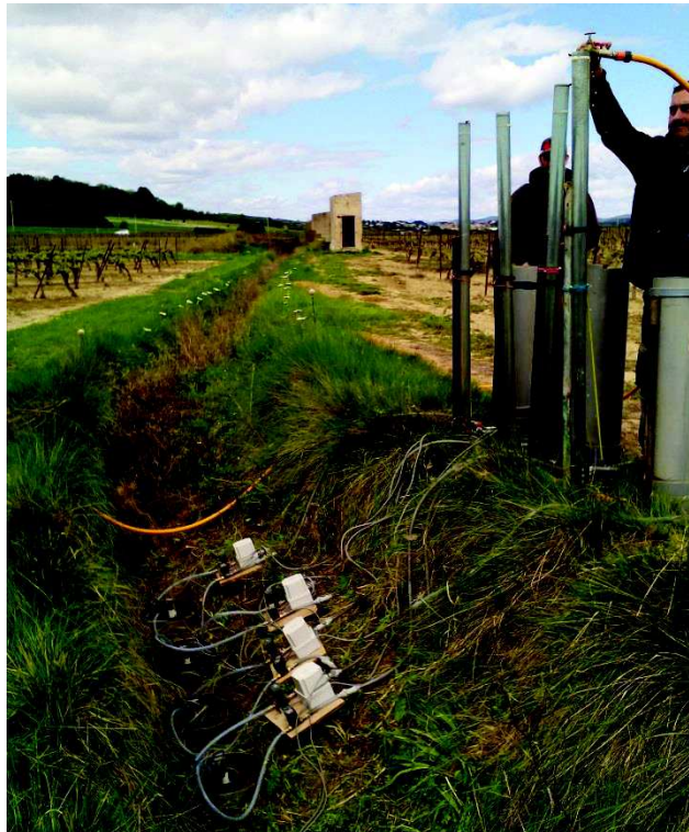
Figure 2.2 : Mesure de la conductivité hydraulique à saturation par la méthode automatisée des doubles anneaux de Müntz.
