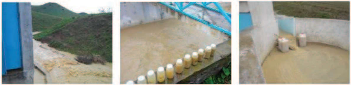
Figure 28 Collecte manuelle de sédiments (Crue 18-12-2014)
