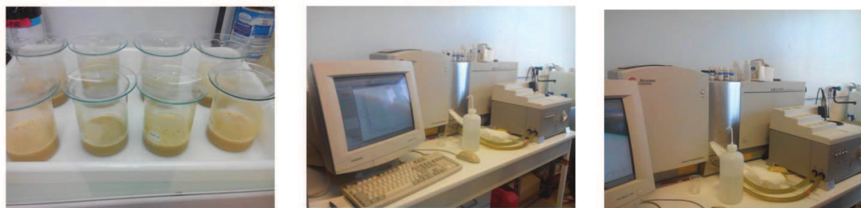
Figure 29 Détermination de la granulométrie moyennant un Beckman Coulter LS 13 320 granulomètre
