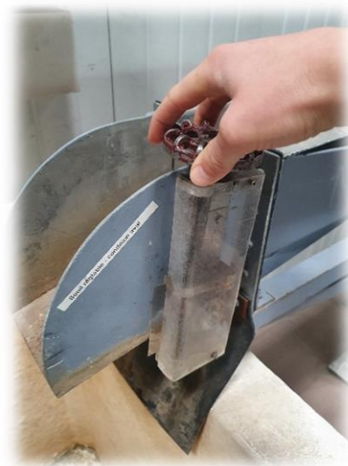
Figure 2 – Seuil aval réglable manuellement
