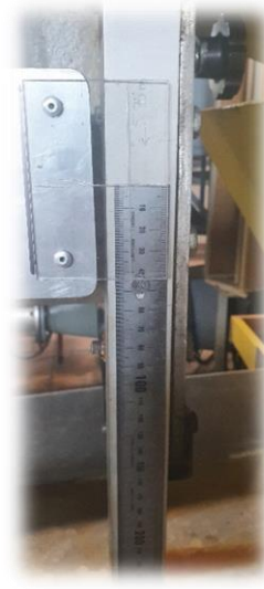
Figure 3 – Réglage pente du canal
