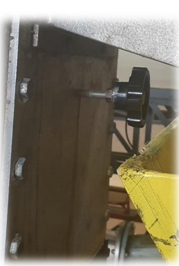
Figure 2 – Seuil aval réglable manuellement
